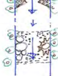
Abb. 3.1.a: Prinzipskizzen geeigneter Einbauten für Vitalisierungsmaßnahmen im Profil (unvollständige Auswahl). Die Abstände der Einbauten sind nicht maßstäblich (stark gestaucht).
