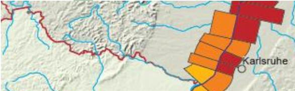
Von Basel aus erreicht die Hochwasserwelle Karlsruhe nach Staustufenbau mehr als doppelt so schnell wie vorher.
